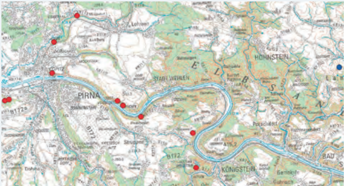
Abbildung 6-33: Lage der Erdrutsche und Muren vom August und September 2010 (rot) und der Rutschung vom Januar 2011 (blau) in der Sächsischen Schweiz. Die Erdrutsche in Mutzschen und Eilenburg sind nicht kartographisch dargestellt. (Datengrundlage: Felssturzdatenbank des LfULG.)
