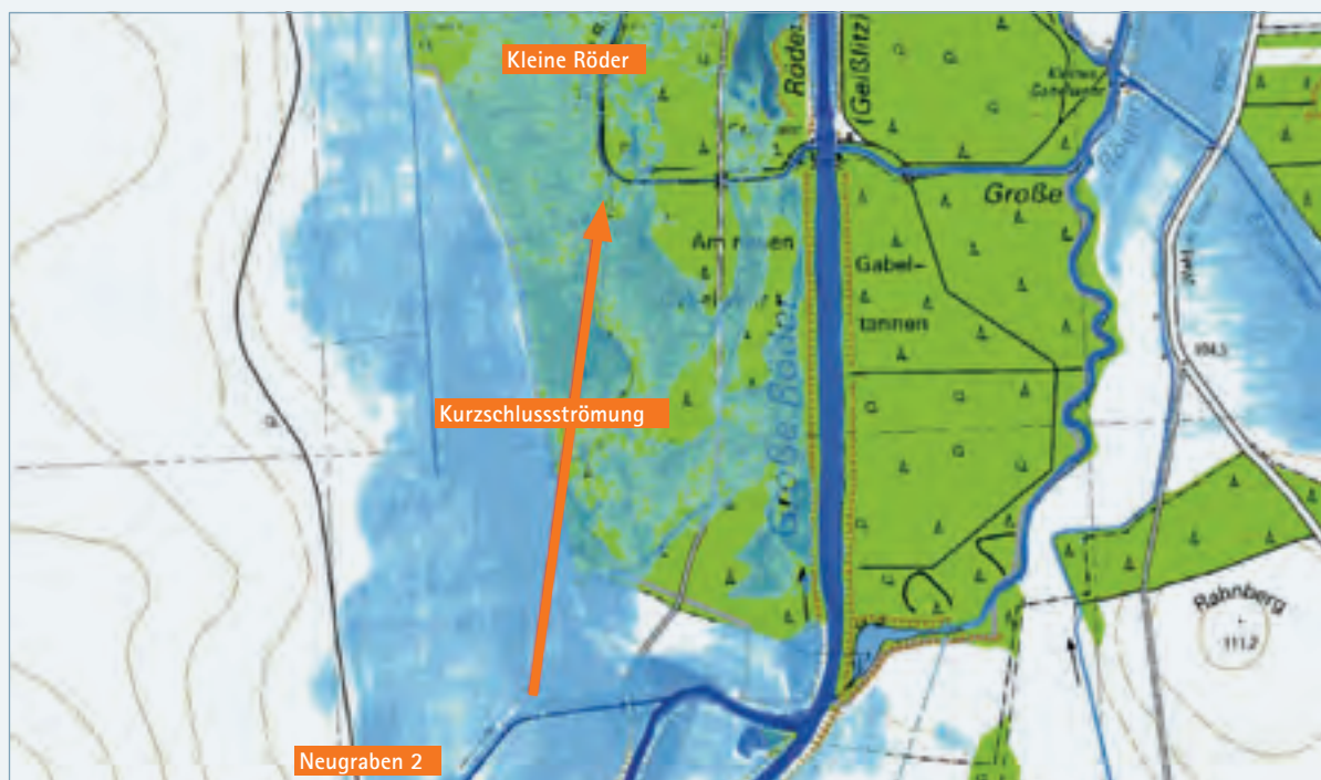
Abbildung 5-4: Die Kurzschlussströmung zwischen Neugraben 2 und Kleiner Röder beim Hochwasser im September 2010 (Quelle: Koban & Schuckert Ingenieurpartnerschaft 2012a)
