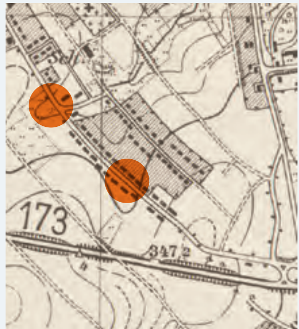
Abbildung 6-27: Nicht maßstabsgetreuer Auszug aus dem Meßtischblatt 5143, Chemnitz, 1943. Der rechte orange Kreis markiert die nun in der Abflussbahn errichtete Bebauung, die Abflussbahn im Bereich des linken Kreises ist noch frei von Bebauung (Quelle: SLUB Dresden/Deutsche Fotothek + Kartensammlung).
